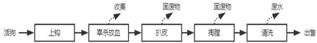
图3-4 改扩建前活狗屠宰工艺及产污环节流程图
